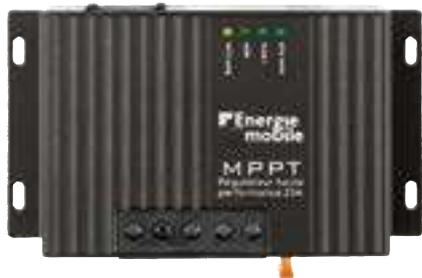
✓ Les MPPT DUO12 et 25 sont équipés de **2 sorties batteries**, ce qui les destine principalement aux véhicules ou aux bateaux équipés de batteries moteur et auxiliaire. La sortie batterie moteur est limitée à 1 A afin de favoriser la recharge de la batterie auxiliaire.
