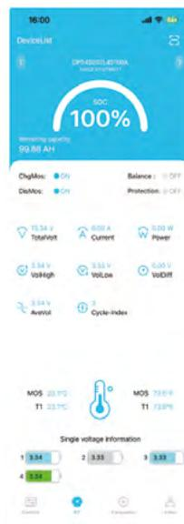
**1. Informations sur la capacité :** Lorsque la batterie est inactive, l'application n'affiche que le pourcentage de l'état de charge (SOC) de la batterie et la capacité restante. Pendant la charge, elle indique le temps estimé jusqu'à la charge complète ; pendant la décharge, elle indique le temps estimé jusqu'à la vidange.
